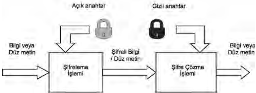
Şekil 2.2. Açık Anahtarlı Şifreleme ve Şifre Çözme İşlemi
